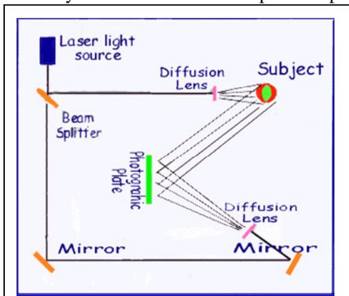
Figure 25. Producing a hologram<sup>24</sup>
