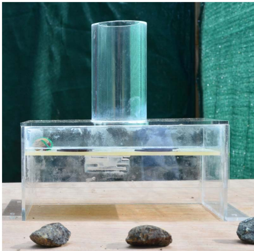
Figure 1. Single stone dropping apparatus. doi:10.1371/journal.pone.0103049.g001
