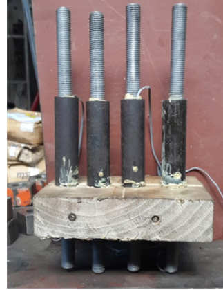
b) Epoxy injection
