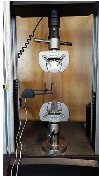
Fig. 3 Tensile coupon test
